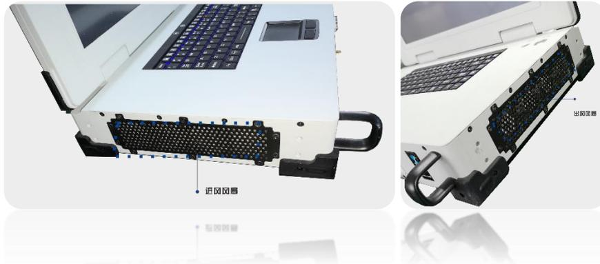
EXMC-2102 机箱一共有 8 个系统风扇，4 个进风风扇，4 个出风风扇。风扇的最大转速为  $7400 \pm 10\%$  RPM，单个风扇的最大风量可达 20.22 CFM。系统风扇有 2 种工作模式，可通过风扇转速控制开关进行设定：
